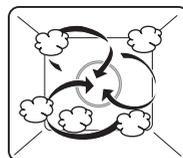
La camera di cottura viene riscaldata contemporaneamente con vapore e aria calda. L'alimento viene riscaldato e portato a cottura con il vapore.
